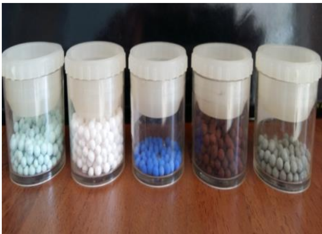
Каталитикалық сорбенттердің синтезделген үлгілері
